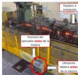
El posicionamiento del operador en fase de montajes era por fuera del cerramiento y con visibilidad reducida
