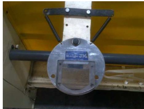
2. Guarda circular protectora de la cuchilla
